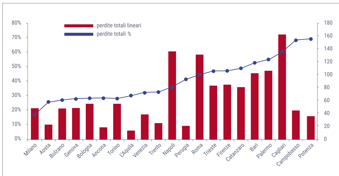
Figura 6. Perdite totali percentuali e lineari nei Comuni capoluogo di Regione. Valori percentuali sui volumi immessi in rete e metri cubi giornalieri per chilometro di rete. Fonte: ISTAT-Istituto Nazionale di Statistica, Censimento delle acque per uso civile.
